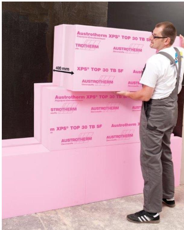
Die Dämmplatte „Austrotherm XPS TOP TB“ mit bis zu 400 Millimeter Dicke wird mit Hilfe des neuartigen Thermobonding-Verfahrens hergestellt. Sie ist hoch wärmedämmend und spart – da sie einlagig verlegt wird - wertvolle Arbeitszeit.
